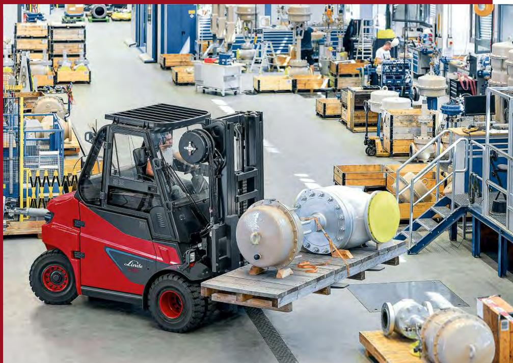
die Stapler mit und ohne Last auf 20 km/h Fahrgeschwindigkeit – ein deutliches Plus im Vergleich zu den entsprechenden Blei-Säure-Modellen. Hinzu kommt die große Robustheit der schwergewichtigen Stapler, vor allem mit
